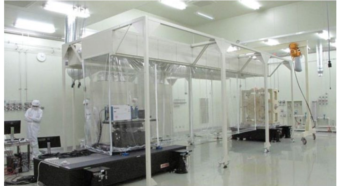
ミラーの曲率半径が非常に大きい(~8m)ため、大気ゆらぎなどの擾乱除去が課題。簡易空調ブース、Zygo DynaFiz干渉計を用いた。
