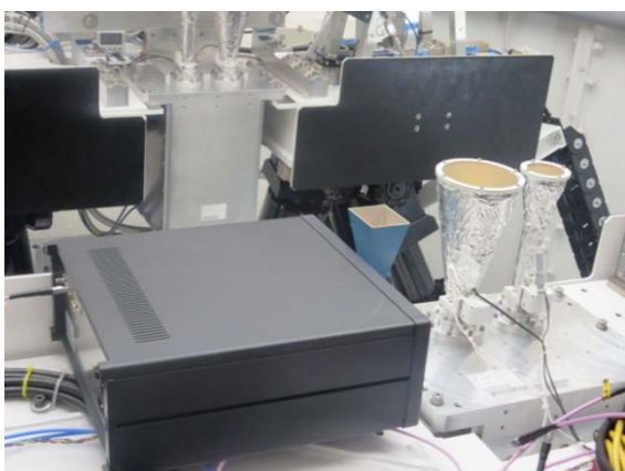
写真 4 簡易型 WVR の水沢 20m 鏡への設置
