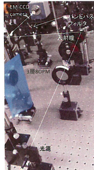
図: 北海道大学で構築している3層8分割位相マスク(80PM) 評価のためのコロナグラフシミュレータ。
