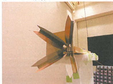
図1: 22年度製作のTSAを利用した4素子アレイの外観とビームパターン(4GHz)
