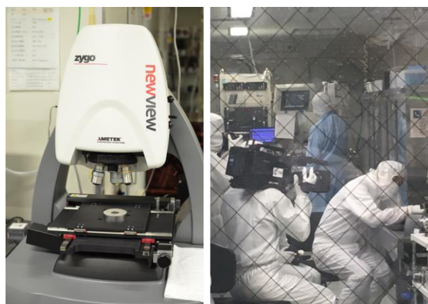
図 2 : (左) NewView8300 にセットされた国友望遠鏡の主鏡。(右) クリーンルーム内での測定の様子。
