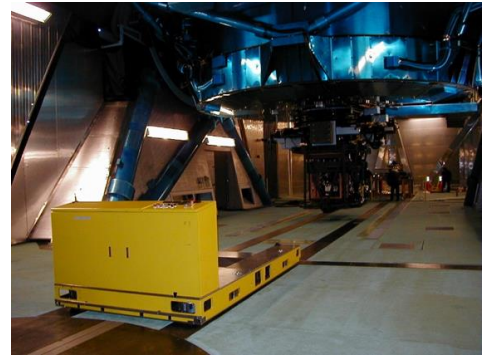
図 1 CIAX による観測装置の取り付け
