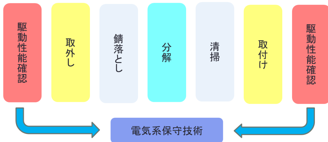
図2 VERA 小笠原局 EL 減速機錆補修の作業工程
