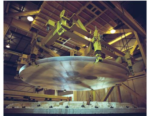
ULE 鏡材の例（すばる望遠鏡）
