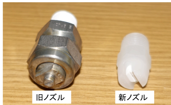
図 3 従来のノズル(左)と樹脂ノズル(右)
