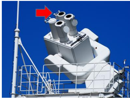
図 1: (左)京都大学理学研究科附属飛騨天文台の SMART 望遠鏡。赤い矢印が SDDI の鏡筒。(右)SDDI の光学系。口径 200mm、焦点距離 1086mm、UTF 透過幅 0.25 \text{ \AA} 、露出時間 2m 秒、73 波長観測。
