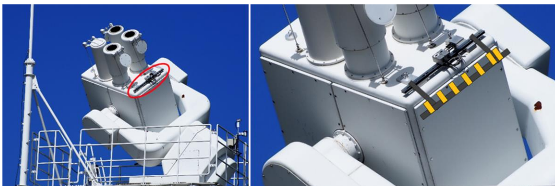
図 5 : SMART 望遠鏡への SHABAR 取り付け位置と取り付け予想図。
