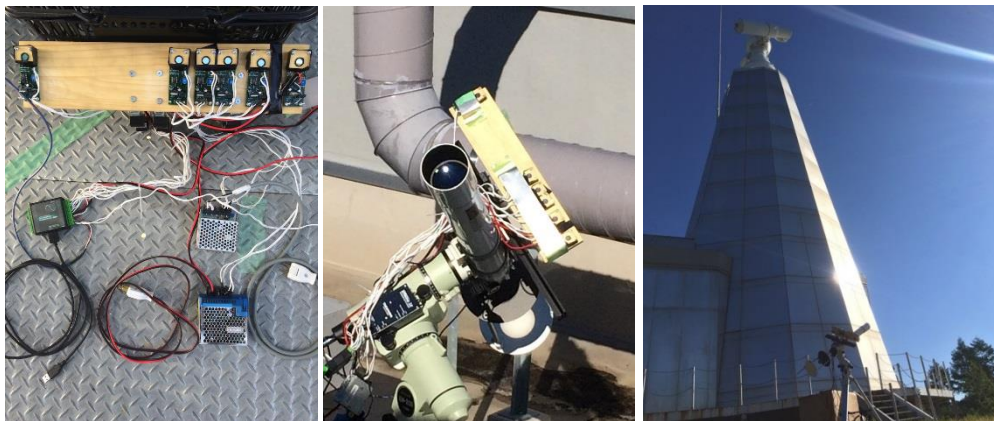
図 1 左：シンチレーションモニタ 中央：観測風景 右：SLODAR との同時観測風景
