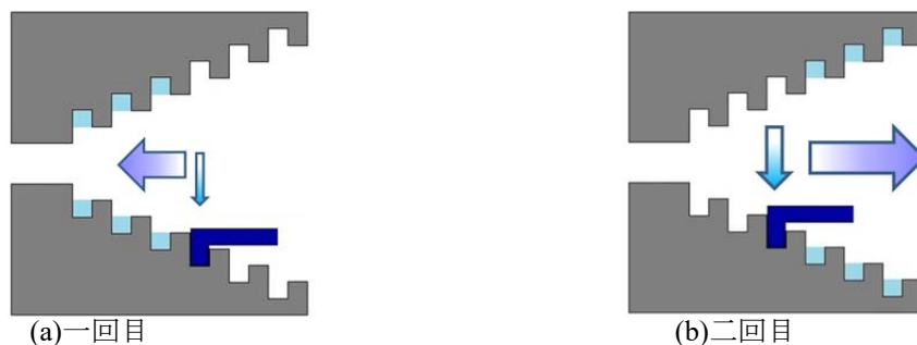
図 - 4 加工手順(3) 溝の仕上げ加工
