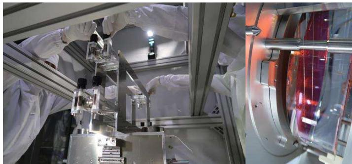
図 9. ウィンチシステムと懸架された BS
