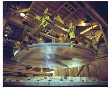
ULE 鏡材の例（すばる望遠鏡）
