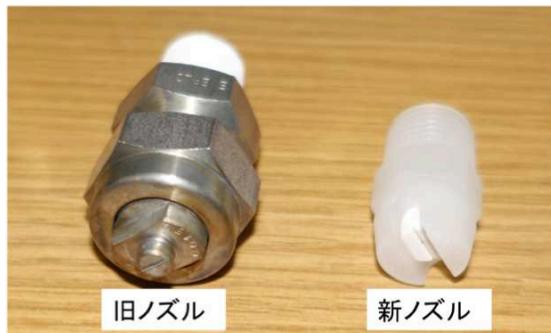
図 3 従来のノズル(左)と樹脂ノズル(右)
