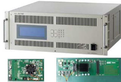
図 1 : OCTAD-S (上) と ADC (下左) 及び FPGA (下右)
