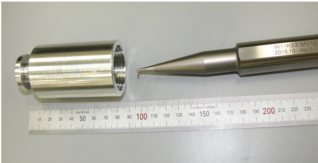
図 1：今回試作したコルゲートホーンと使用した刃物
