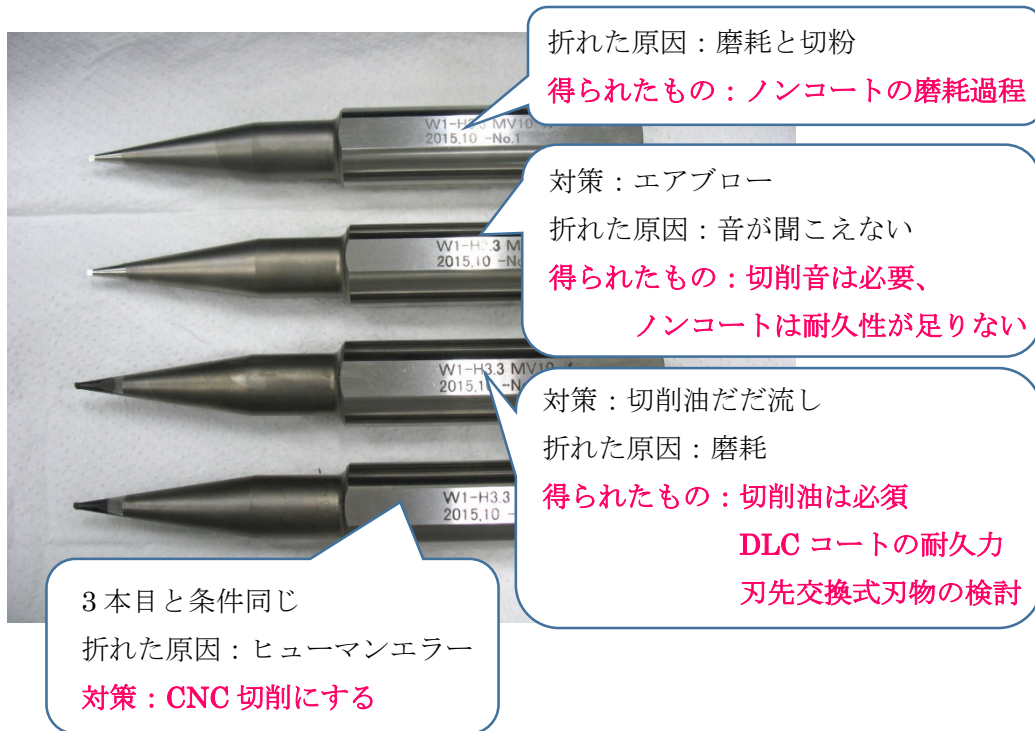
図 4：刃物欠損原因と対策、そこから得られたもの
