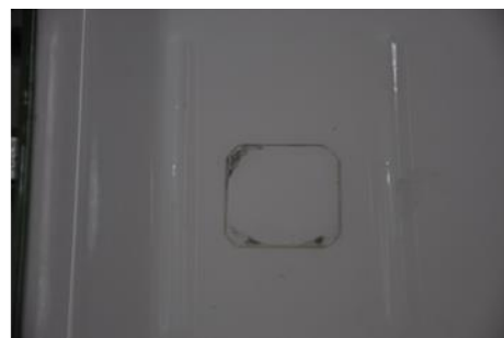
図 1 旧リオ・フィルター機械駆動部の汚れ（金属微粉末）と素子汚染状況
