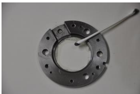
図 1 旧リオ・フィルター機械駆動部の汚れ（金属微粉末）と素子汚染状況
