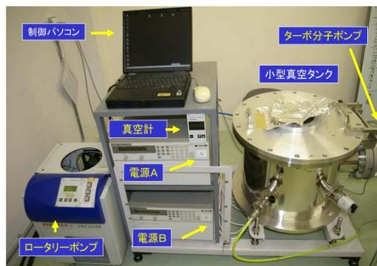
小型蒸着窯と制御装置
