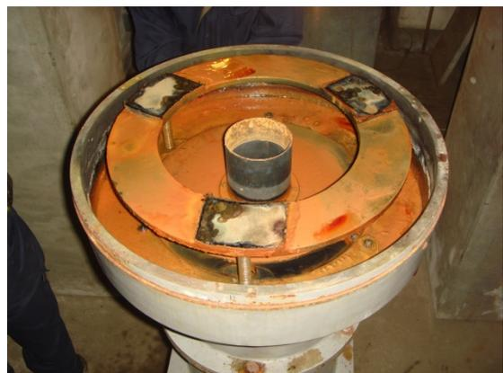
写真12 反射膜の剥がれた様子 写真13 セル内に結露した水による錆の様子
