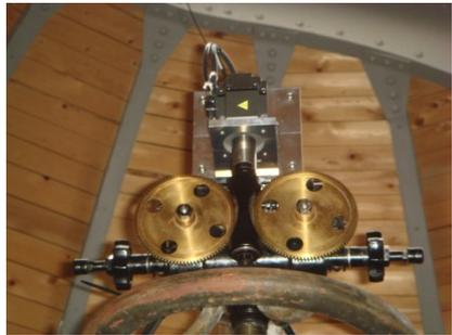
写真9 ツァイスの駆動機構 写真10 第1鏡部駆動部 写真11 第2鏡部修復後
