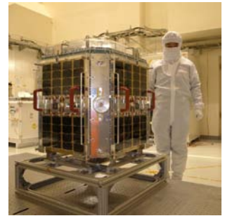
図1 Nano-JASMINE衛星 フライトモデルの外観 サイズはおおよそ50cmx50cmx50cm、重量はおおよそ35kgである。
