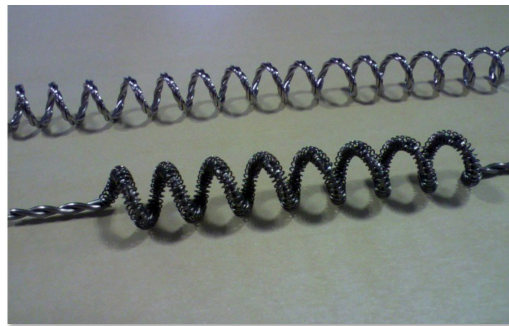
▲図4：タングステンフィラメント（上）とタングステンネットを巻いたフィラメント（下）
