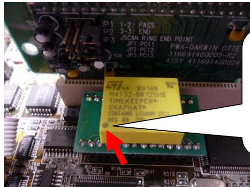
この黄色い部品が電池ですが、表示文字を上向きに、更に左下の「●」が左に配置されるようにセットする。
